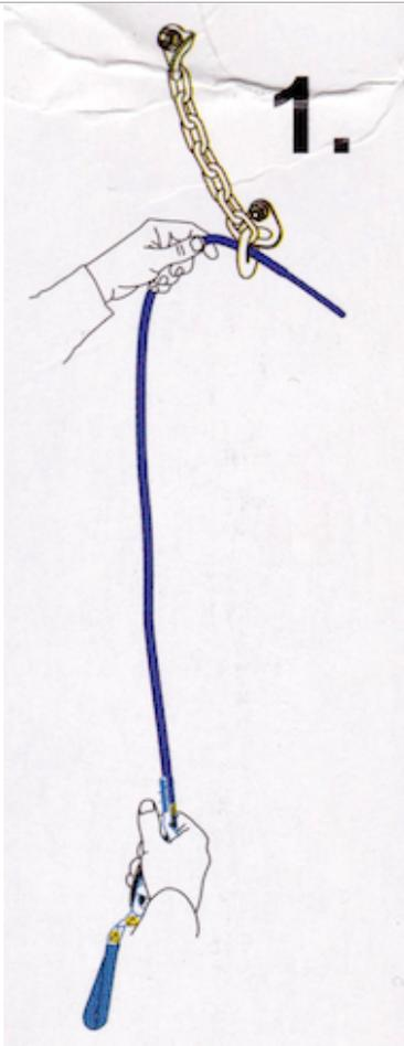
Anbringen des ESCAPER an einem fixen Anschlagpunkt ausreichender Tragkraft
