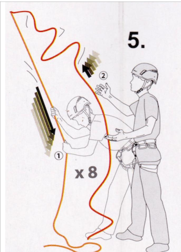
Unten angekommen mindestens 8 mal ziehen und 8 mal zupeln - das ESCAPER System löst sich von dem fixen Anschlagpunkt
